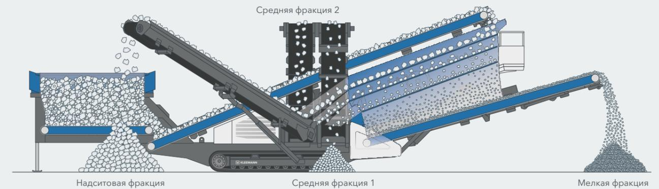
Благодаря компактным транспортировочным размерам, короткому подготовительному времени и большому выбору просеивающих панелей сортировочные грохоты MSC EVO подходят для универсального применения. Поток материала обеспечивает эффективную обработку больших объёмов: начиная с приёмного бункера, расширяющегося по направлению потока материала, загрузочного конвейера увеличенной ширины
