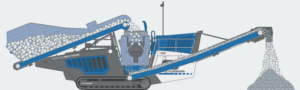
Die MOBICONE MCO 110(i) PRO verfügt über einen einfachen Schiebemechanismus der Aufgabereinheit, der die Maschine in eine kompakte Transportposition bringt und ein schnelles Setup ermöglicht. Durch den Schiebemechanismus kann zudem die Materialabwurfparabel in den Brecher einfach angepasst werden - für eine optimale Beschickung.
