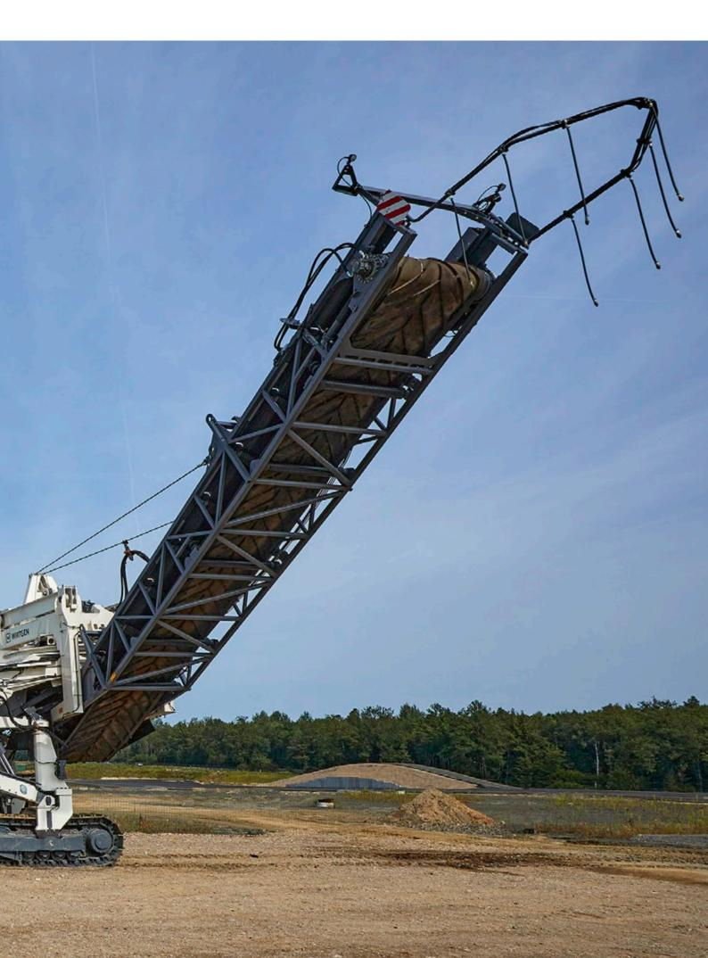
Potente Surface Miner para la obtención fiable y selectiva de materias primas mediante carga directa, desplome lateral o «Cut to Ground». Las materias primas se obtienen en una sola pasada, sin perforación ni voladura, de forma ecológica, con la calidad más pura y fragmentadas directamente. La cinta de carga trasera potente, elevable y giratoria, con contrapeso desplazable y un flujo de material perfecto, permite la carga de camiones de carga pesada con una carga útil de hasta 100 toneladas.
