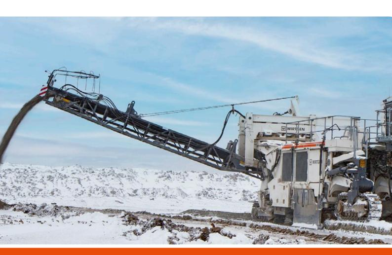
01 Un radio de giro inferior a 9 metros y la buena maniobrabilidad permiten maniobras de giro rápidas
