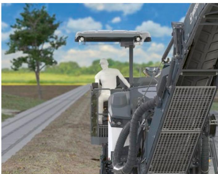
Le toit protecteur réglable verticalement et latéralement offre une protection optimale dans les différentes positions de travail - en particulier dans les conditions exigues.
