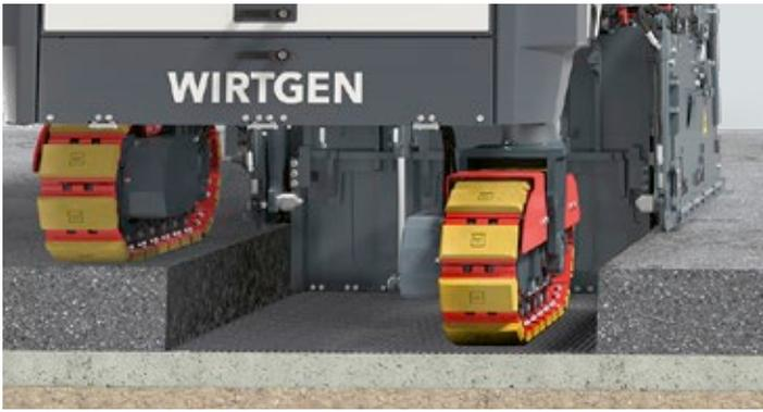
Groupe de fraiseur FB1500 avec Multiple Cutting System **MCS BASIC**.
