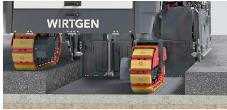
Groupe de fraiseur FB1800 avec Multiple Cutting System **MCS BASIC**.
