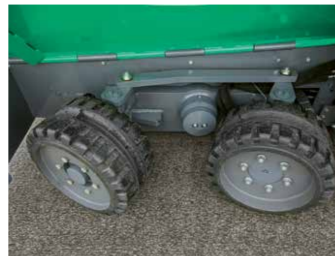
Ruedas delanteras montadas sobre bogies. Proporcionan una superficie de apoyo continua de las ruedas incluso al trabajar sobre una base irregular.
