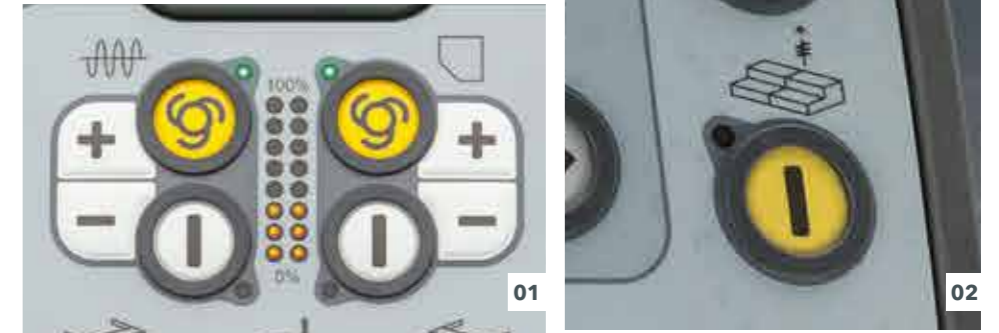
01 Función de precompactación 02 Descarga de la regla (opcional)
