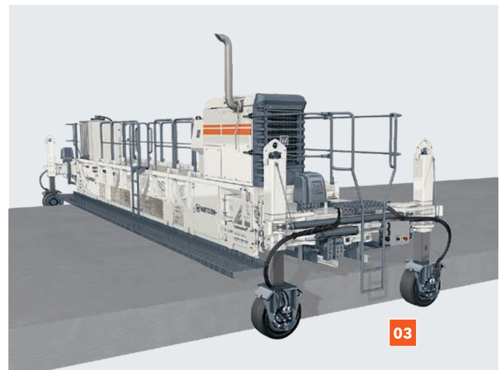
TCM 95(i) ist mit vier Rad-, TCM 180(i) mit vier Kettenfahrwerken bestückt.
