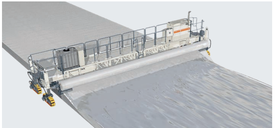
Folienwickelvorrichtung für effektiven Betonschutz bei Regen.
