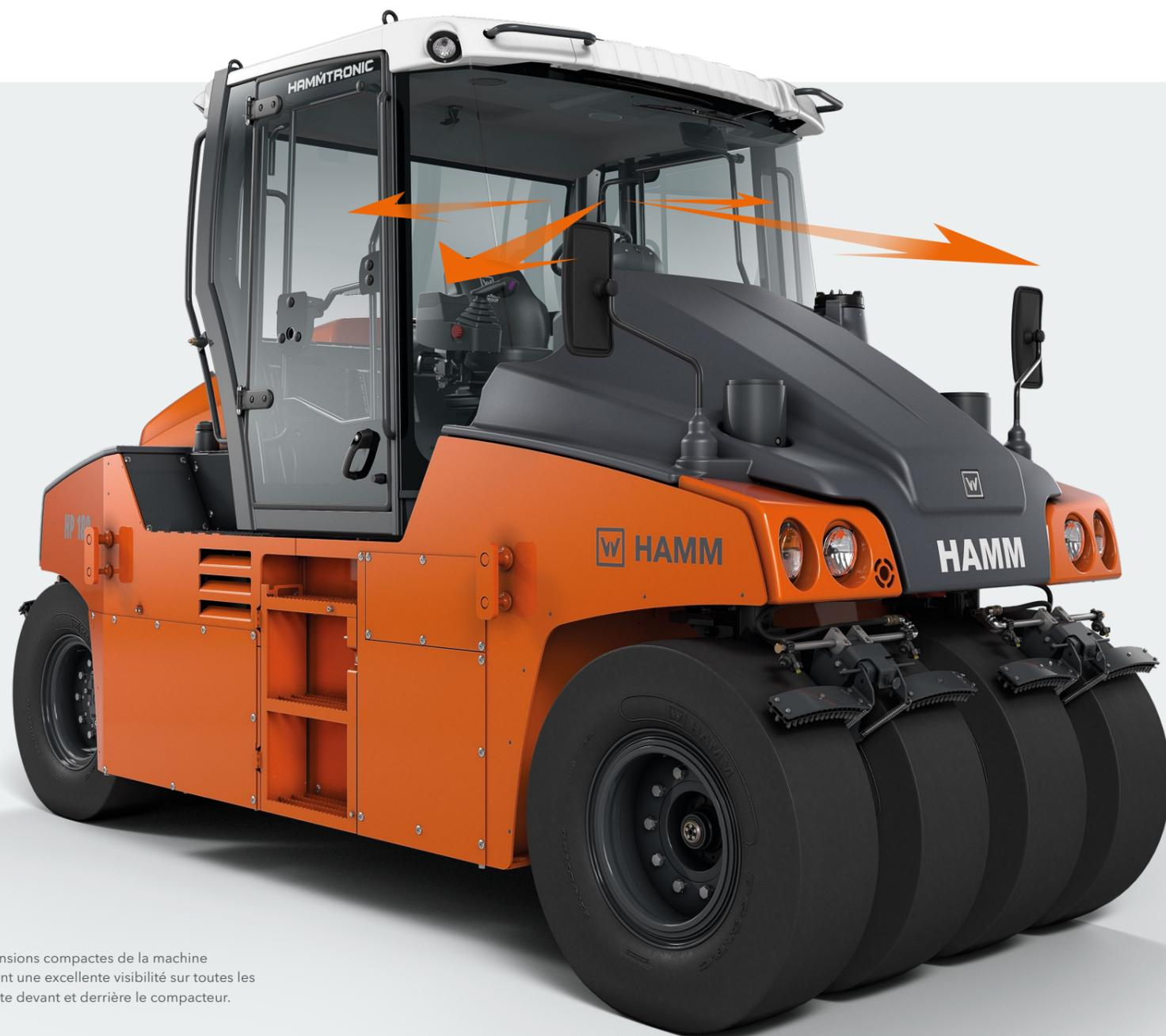
Les dimensions compactes de la machine permettent une excellente visibilité sur toutes les zones juste devant et derrière le compacteur.
