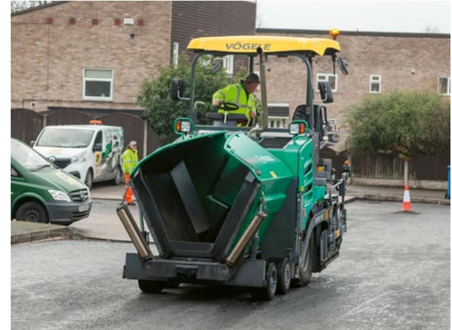
Para o transporte, a capota rígida, feita de um material polimérico reforçado com fibra de vidro, e o tubo de escape podem ser dobrados em apenas alguns movimentos rápidos, preparando a vibroacabadora para transporte rápido e fácil.
