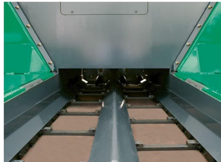
O transportador pode ser revertido ao toque de um botão. O transporte de retorno da mistura é interrompido automaticamente. O transportador pode ser trocado para a função sem carga com a mesma rapidez.
