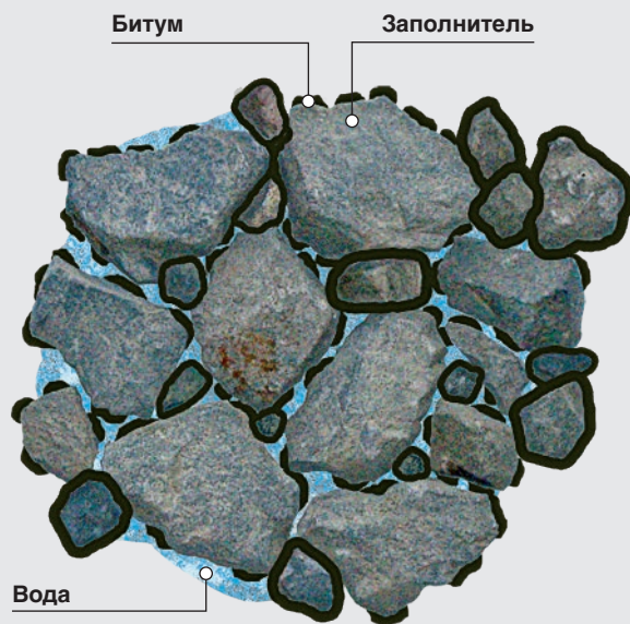
Б Для достижения оптимального уплотнения стабилизированный битумом материал со вспененным битумом смешиваются с водой.
