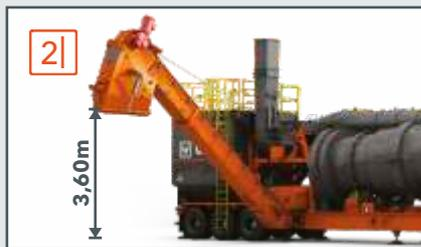
2| Descarga de masa asfáltica.
