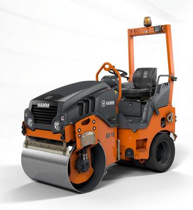
タンデムローラ シリーズ HD CompactLine バイブレーションドラムとホイールセット付きタンデムローラー H262
