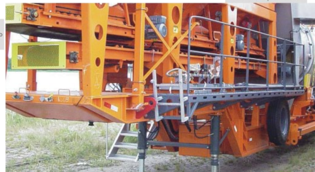
Plataforma de Inspección de Silos
