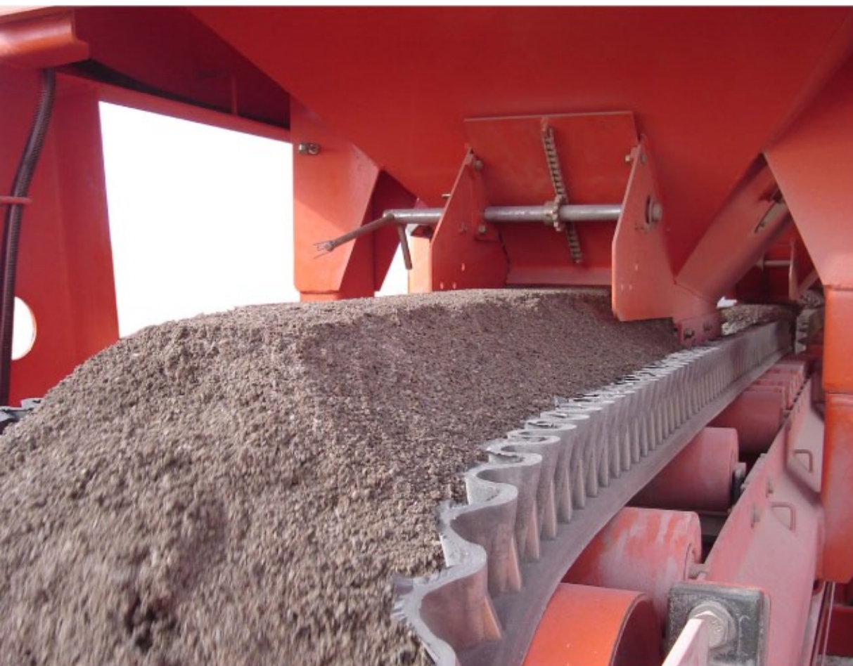
Cintas dosificadoras con protecciones laterales vulcanizadas
