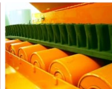
Cintas dosificadoras con protecciones laterales vulcanizadas
