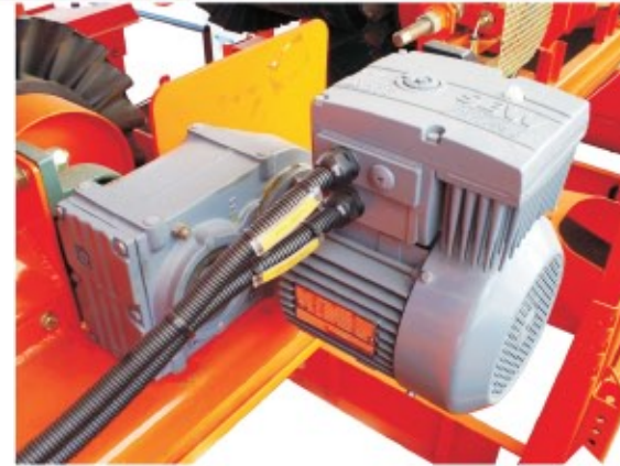
Motorreductor con inversor de frecuencia acoplado.
