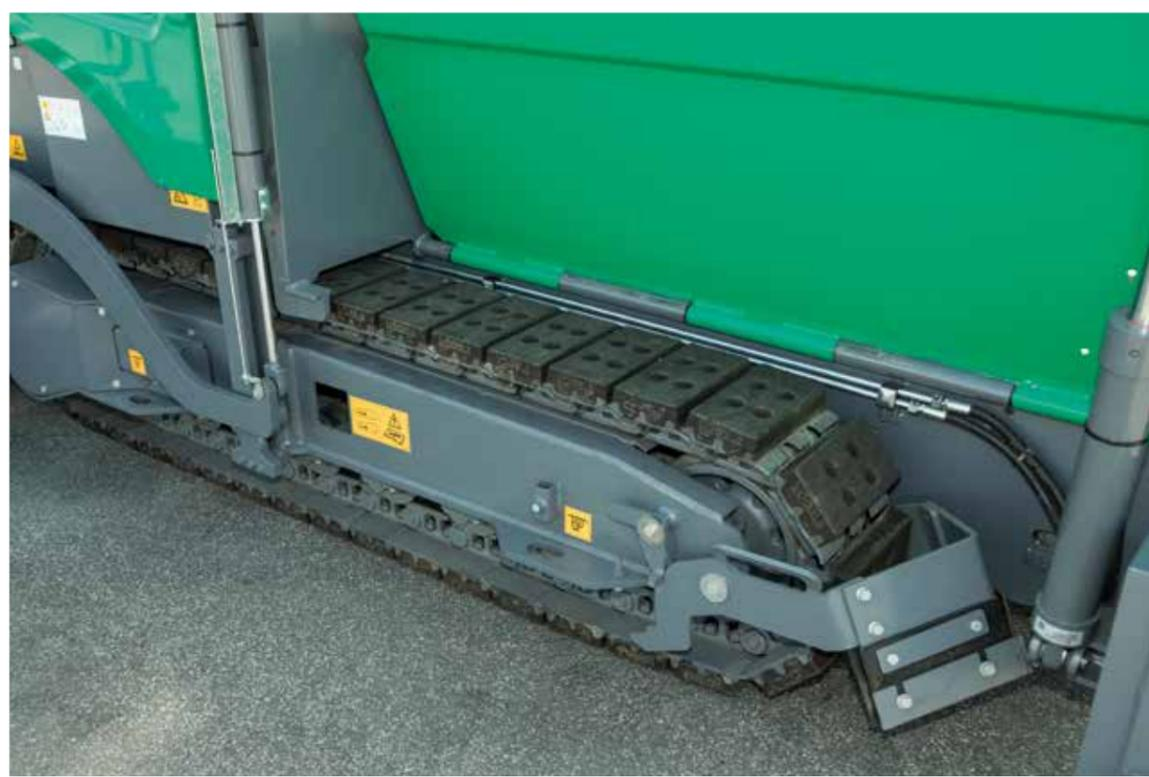
» **Les systèmes hydrauliques** de l'entraînement de translation, des systèmes de convoyement et de répartition du matériau ainsi que ceux des groupes de compactage fonctionnent en circuits fermés indépendants et atteignent ainsi une efficacité optimale.
