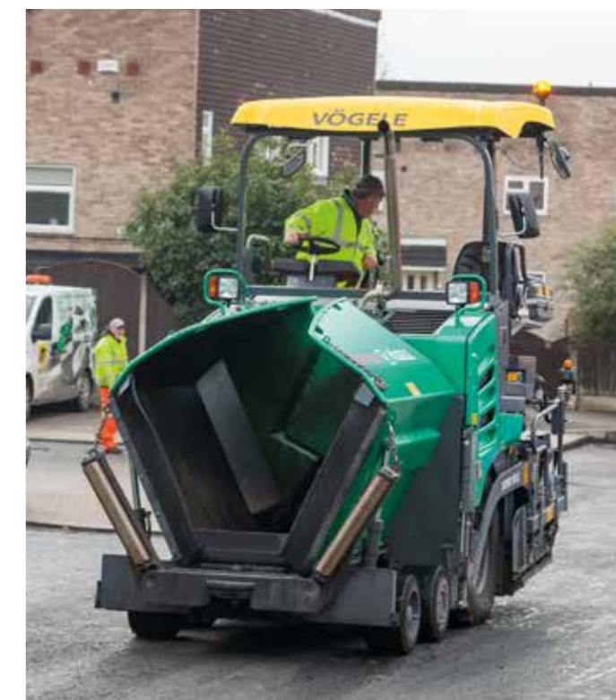
Lorsque l'on relève les parois de la trémie, les rouleaux-pousseurs se relèvent automatiquement aussi.
