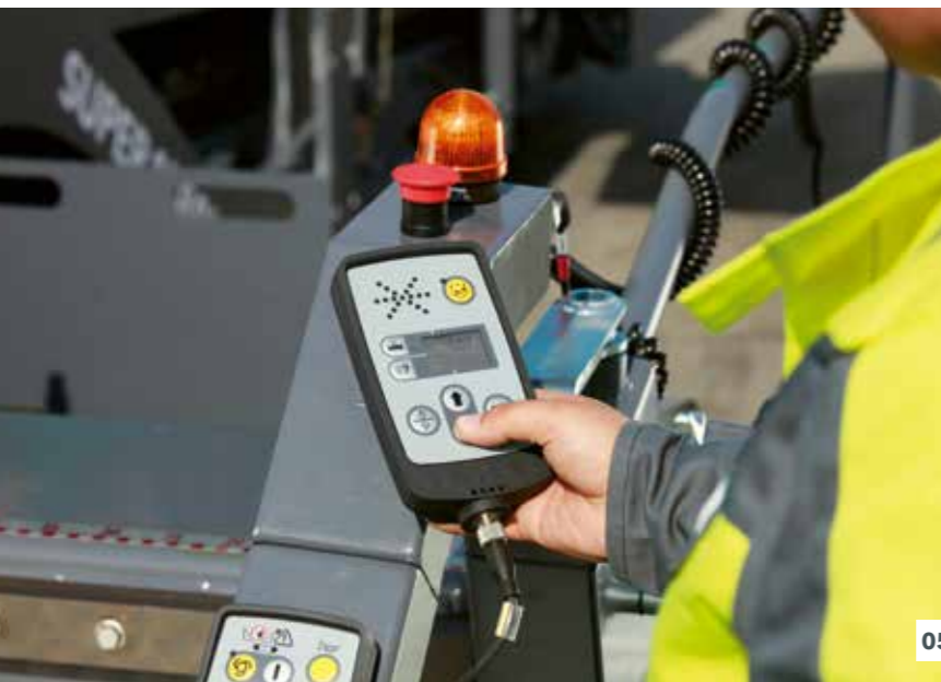
01 ถังใส่วัสดุขนาดใหญ่ที่ปรับเป็นพิเศษสำหรับรถผสมคอนกรีตขนาดใหญ่พิเศษ 02 มอเตอร์ขับเคลื่อนแยกที่ต่อเข้ากับล้อนำ 03 การดำเนินงานที่ง่ายด้วยระบบการดำเนินงาน ErgoBasic ที่เป็นนวัตกรรม
