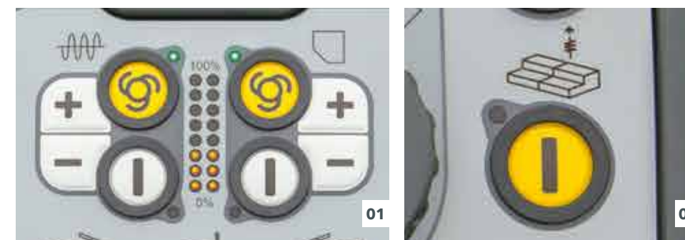
01 Выполнение предварительного уплотнения
