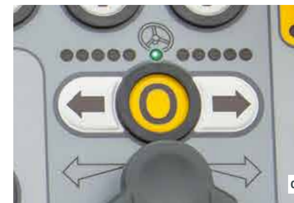
01 Для длинных кривых с постоянным радиусом желаемый угол поворота может быть предварительно установлен при помощи клавиш со стрелками.
