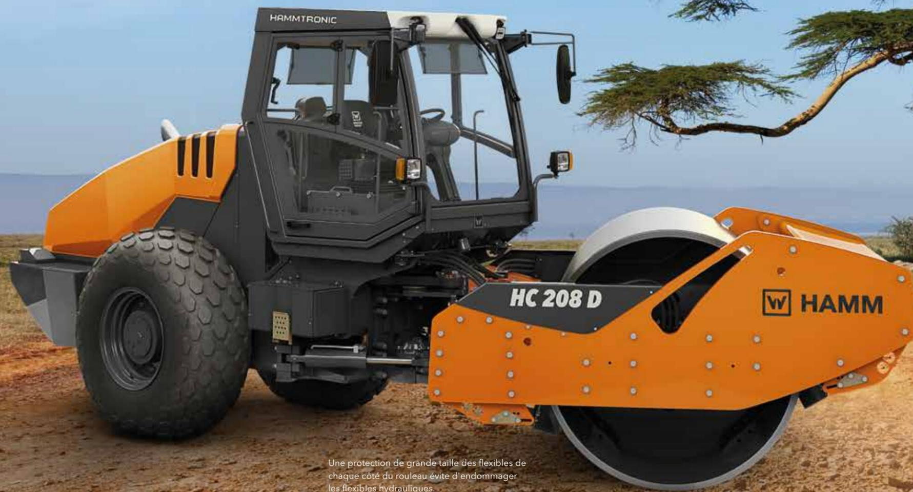
Une protection de grande taille des flexibles de chaque côté du rouleau évite d'endommager les flexibles hydrauliques.
