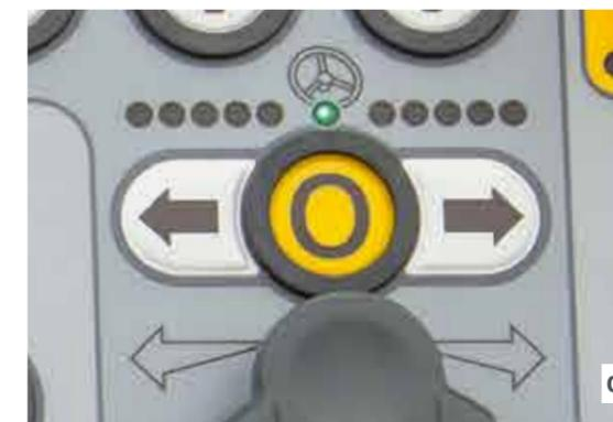
**01** Para curvas largas con un radio constante, el ángulo de dirección deseado puede preseleccionarse utilizando teclas de flechas.
