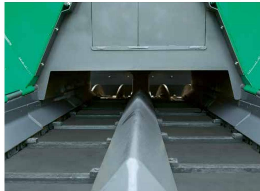
La marcha de la cinta transportadora puede invertirse con sólo pulsar un botón. El retorno de la mezcla se detiene automáticamente. Y con la misma rapidez se puede poner la cinta transportadora en la función de marcha en vacío.
