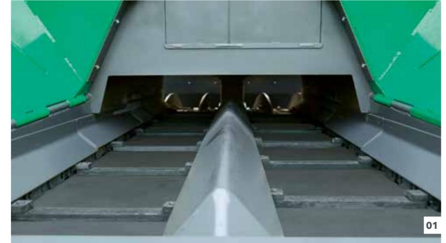
**01** El control proporcional y el monitoreo continuo de los sinfines de distribución garantizan un nivel de mezcla constante delante de la regla de acuerdo con los requisitos actuales.
