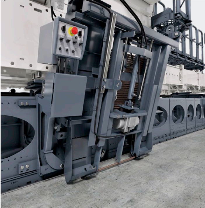
Inseror de barra de ligação longitudinal com unidade operacional.
