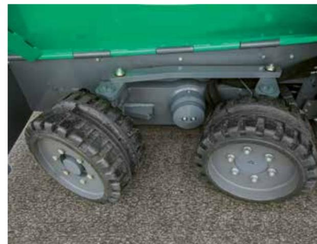
Roues avant montées sur bogies. Ces derniers assurent un contact continu des roues avec le sol, même sur une base irrégulière.
