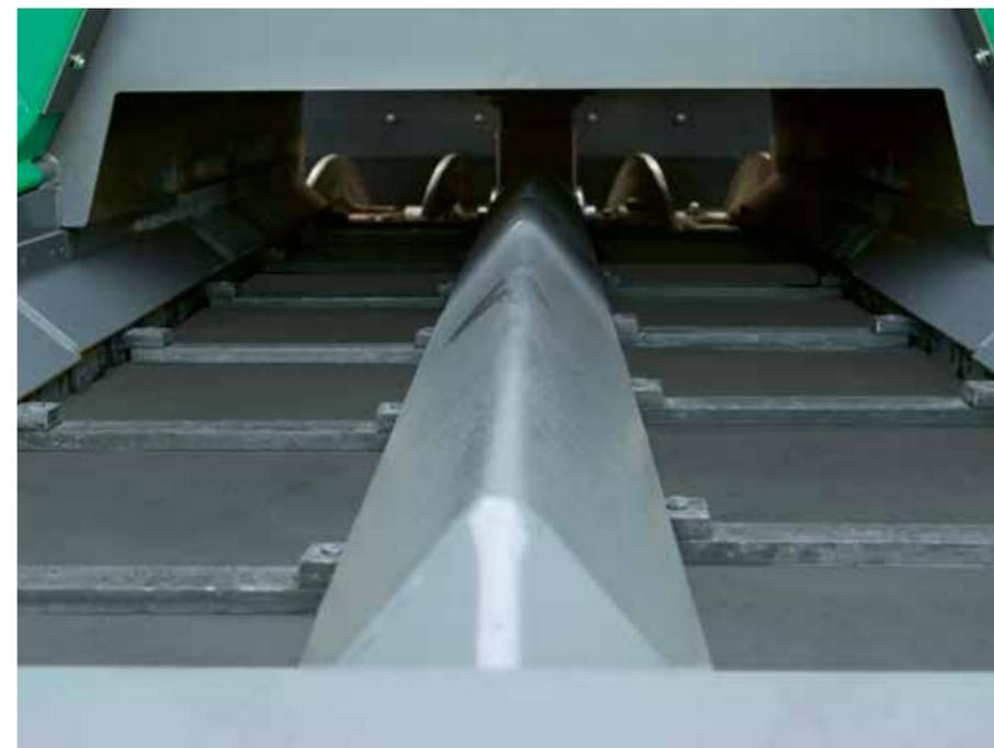
Le sens du convoyeur peut être inversé sur une simple pression de touche. La marche arrière de l'enrobé s'arrête automatiquement. La fonction de marche à vide du convoyeur peut être activée tout aussi rapidement.
