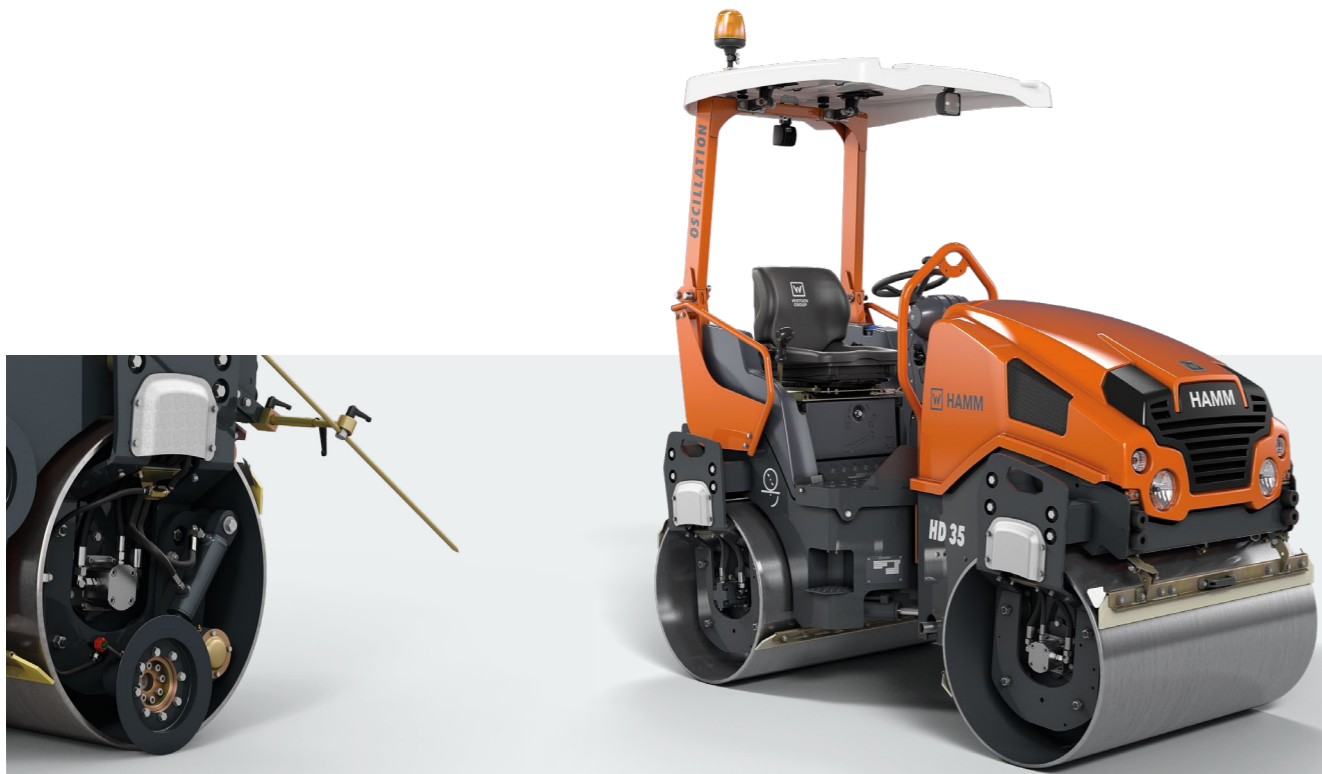
带有轨迹指示器的压边和切边装置
