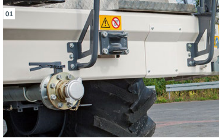
01 所有的连接管都集中布置在前部的横梁上。
