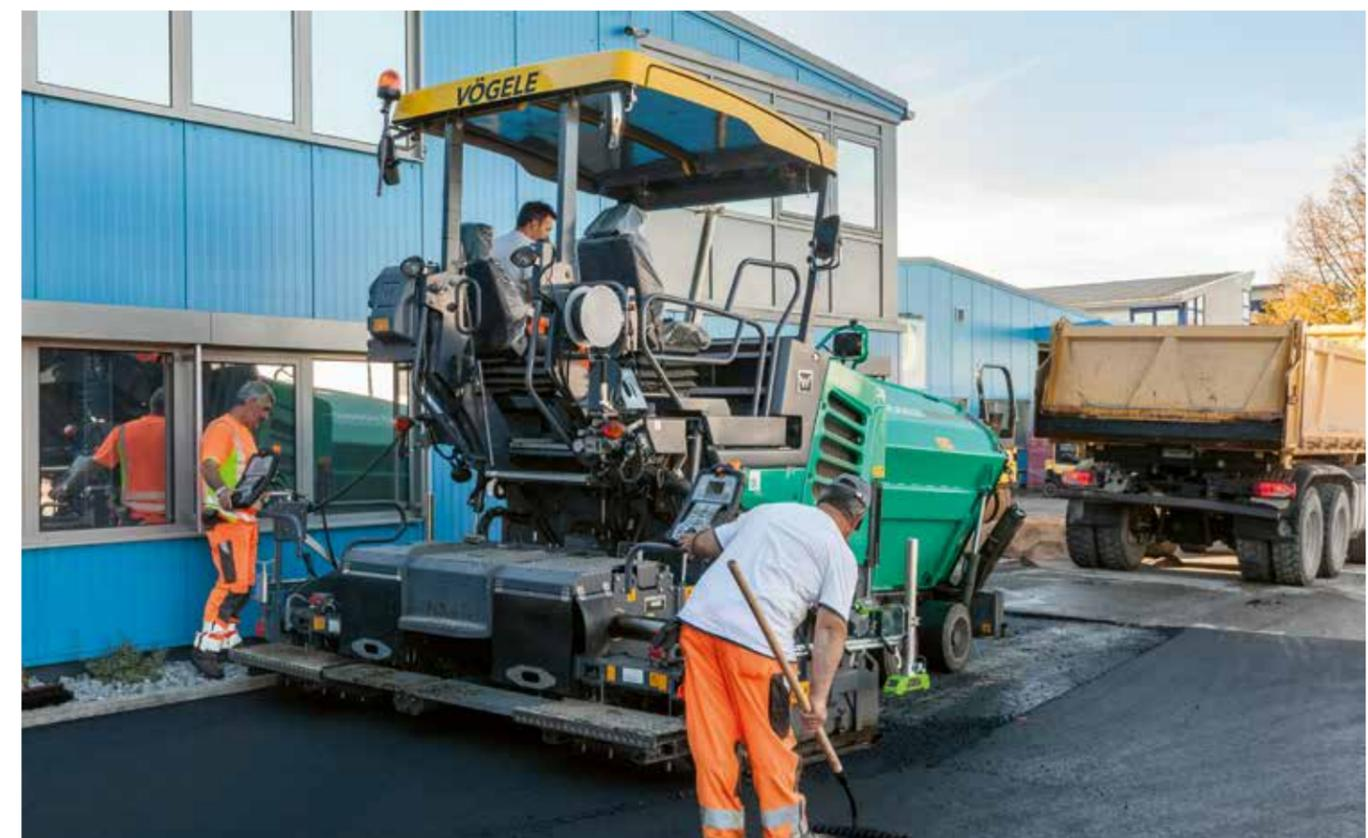
**01** Система управления ErgoPlus 3 с многочисленными функциями, обеспечивающими удобство эксплуатации и автоматизацию процесса.
