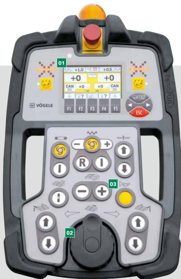
**01** Контрастный цветной дисплей выдает чёткую картинку даже при плохом освещении. Кроме того, освещение мощными светодиодными лампами, направленными вниз, гарантирует оптимальный контроль рабочих процессов по периметру бокового щита.
