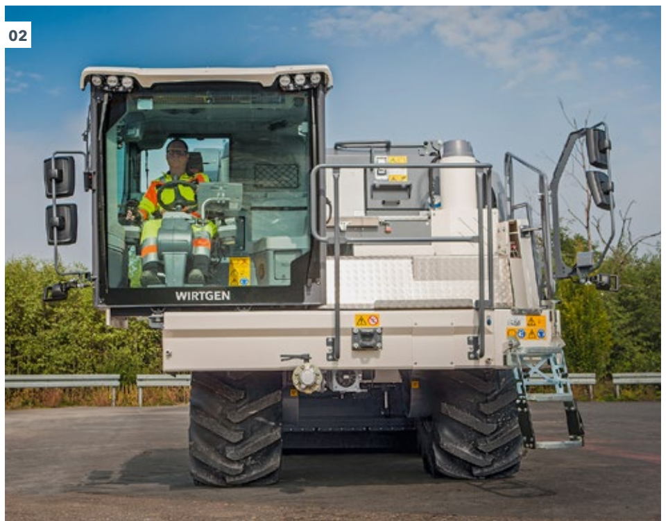
01 - 02 Um z. B. an einem vorausfahrenden Recyclingzug vorbeizuschauen, wird die Kabine hydraulisch weit nach rechts verfahren.
