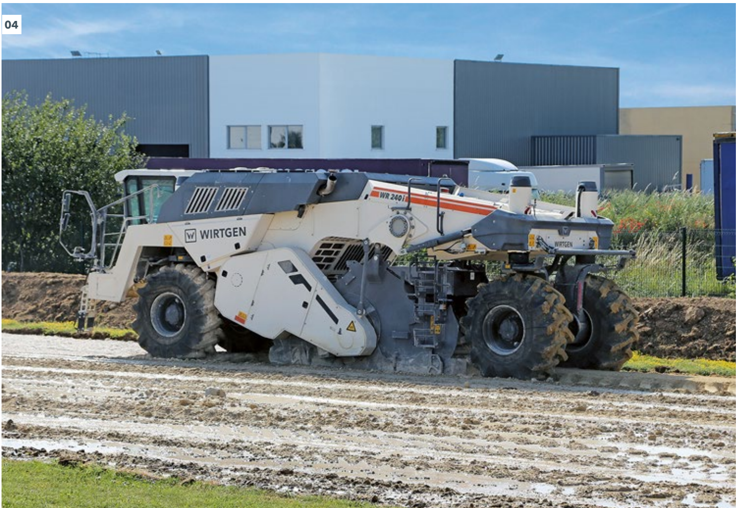
01 - 04 Bei der Bodenstabilisierung wird ungenügend tragfähiger Untergrund in gut einbaufähigen und verdichtbaren Boden verwandelt.
