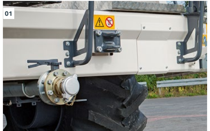
01 Alle Schlauchanschlüsse sind an der vorderen Traverse angebracht.
