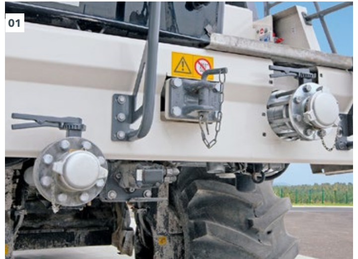
01 Der Anschlussstutzen für Schaumbitumen ist gut zugänglich.
