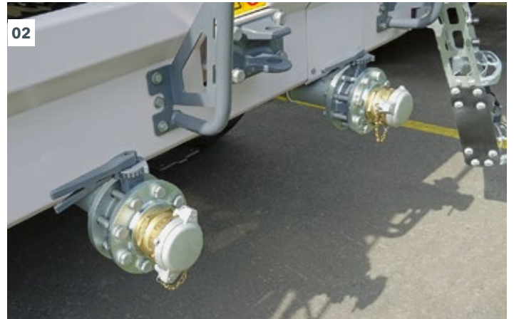
02 Anschlüsse für Wasser und Emulsion sind gut zugänglich.
