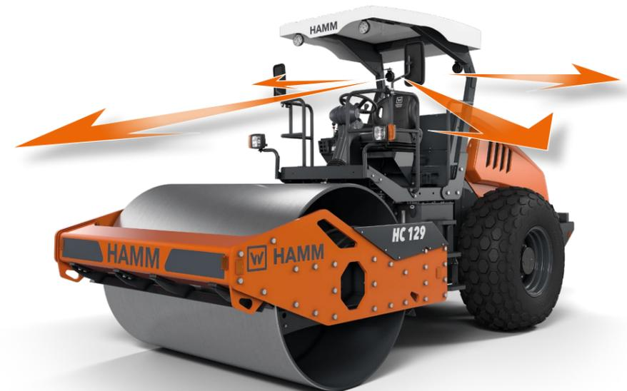
Vue dégagée sur le rouleau ainsi que sur l'arrière et les pneus, sans tuyau de gaz d'échappement gênant.
