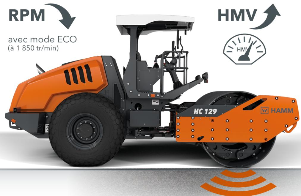
En mode ECO, les compacteurs fonctionnent à une vitesse réduite de 1 850 tr/min. La puissance de compactage reste élevée en permanence.
