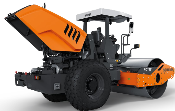
El motor también puede funcionar con combustible B20. Hasta el 20 % de este combustible se obtiene de fuentes biológicas.
