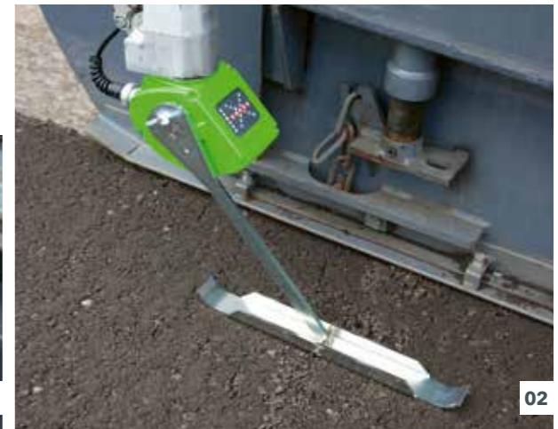
**01** 传感器上还装有 LED 交叉照准线, 它为焙平板操作人员提供连续的、清晰可见的反馈, 显示实际值与设定值是否匹配。
