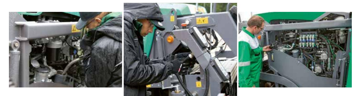
福格勒摊铺机标准的维护保养理念，确保快速、简单的维护保养操作。凭借宽大的铰链门，机器上所有的维护保养点均易于接近。
