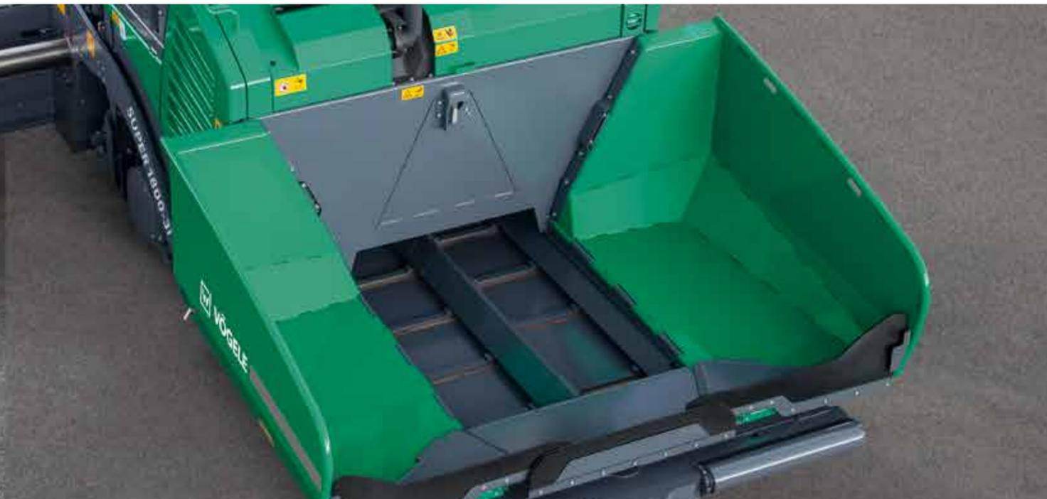
Die Materialquerförderung vor der Bohle bietet beim SUPER 1800-3(i) alle Möglichkeiten, um eine optimale Mischgutvorlage in jeder Einbausituation zu erzielen.
